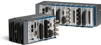
CompactRIO 将开放式、小型化和坚固耐用的嵌入式架构与 C 系列模块集成在一个平台上。平台基于 NI LabVIEW RIO 架构。每个系统包含一个 FPGA，用于自定义定时、触发以及处理一系列可用的模块化 I/O，可满足任何嵌入式应用程序的需求。
